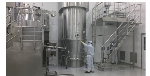
造粒室では、1,200Lの製造スケールを使って一度に数百万錠分の製剤の顆粒を製造しています。
