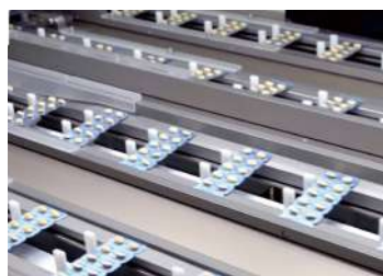
錠剤をPTPシートに充填します。
