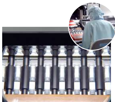
充填後のシリンジに、キズや液漏れ、 気泡がないことを目視で確認します
