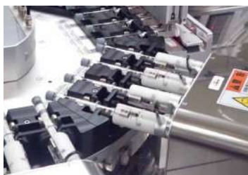
シリンジにプランジャーロットとフィン ガーグリップを取り付けます。
